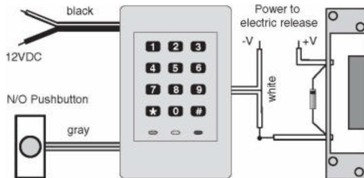
EL esquemático muestra la liberación a 12VDC. El rango de corriente debería ser menor que 5A.
